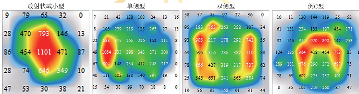
“白蓝青绿黄橙红”颜色代表压强值越来越大;数字显示的是该点压强值;压强数值间距为1 cm
